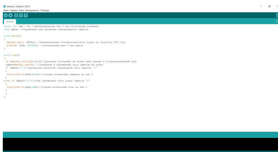
Рисунок 10 – Программа для приемника, написанного в среде Arduino
